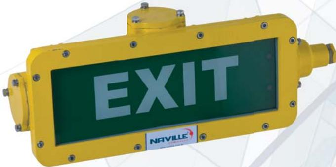
**Bloco de Iluminação de Emergência Ex d a prova de explosão e tD** proteção por involucro, Zonas **1 ou 2, 21 ou 22**, Grupos **IIA/IIIB/IIC, IIIA/IIIB/IIIC**.
