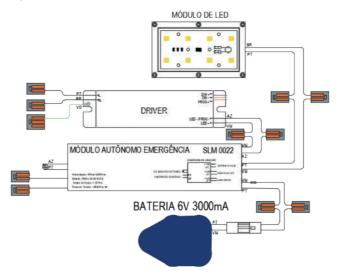
Esquema de ligação extra baixa tensão 12Vcc/24Vcc/125Vcc:
